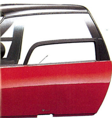
ガルウイングドア ドアを開ける時の前方への張り出し分は、最大でボディヤイトから20mm(片側)。ドア内部には、前方からの衝撃をガードするサイディングバーを備える。
