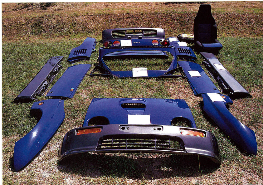
▲ボディ外板は、ボンネット、ルーフに至るまですべてプラスチック製だ。その重量は31kgで、同じ外板をスチール製にした場合より約5kg軽い。また、防錆性能に優れていることも特徴のひとつ。
