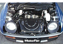
▲エンジンはミッドにマウントされる。エンジンフードを開けるとF6A型パワーユニットがあり、開口部が広くて整備しやすい。このパワーユニットはスズキ統括から供給されるもので、カプチーノと同じエンジンである。最高出力64ps/6500rpm、最大トルク8.7kgm/4000rpmを発揮する。
