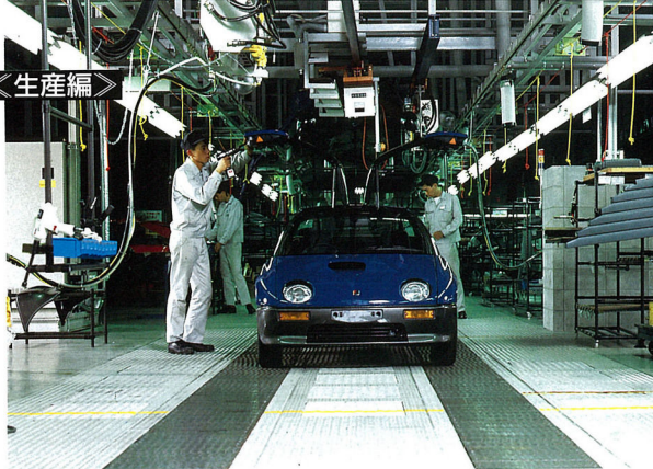
▲AZ-1の組み立てはクラタ殿で行われる。ガルウイングドアの部分をネジ止める様子。完成は間近だ。
