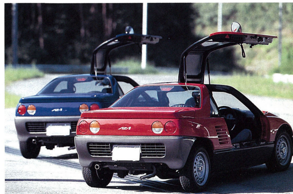
▲カラーリングが美しい2台のAZ-1。最大の特徴は軽自動車として初めて採用されたガルウイング・ドア。
