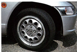
▲ビートは前後でサイズの異なる異径タイヤを装着。前輪が13インチ、後輪は14インチ。
