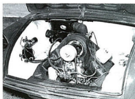
▲4サイクル・空冷V型2気筒エンジン。
