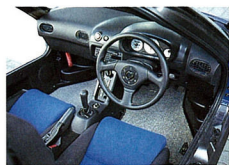
▲オプションのMOMO製本革張りステアリングホイールを装着したA2-1。取り付け費込みで価格3万4000円。装着にあたっては専用ボルトが別途必要。
