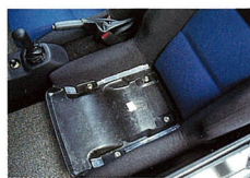
▲助手席シートクッションを刺がすと、シートフレームがフロアパンにボルトで面付けされている様子がわかる。焦点をピタリと定めた設計思想がここにも窺える。
