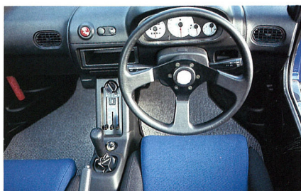
▲AZ-1のインストルメントパネル。3本スポークのステアリングホイール越しに見えるメータークラスターには、中央に大きなタコメーター、左側にスピードメーター、右側に小さく燃料計と水温計がある。
