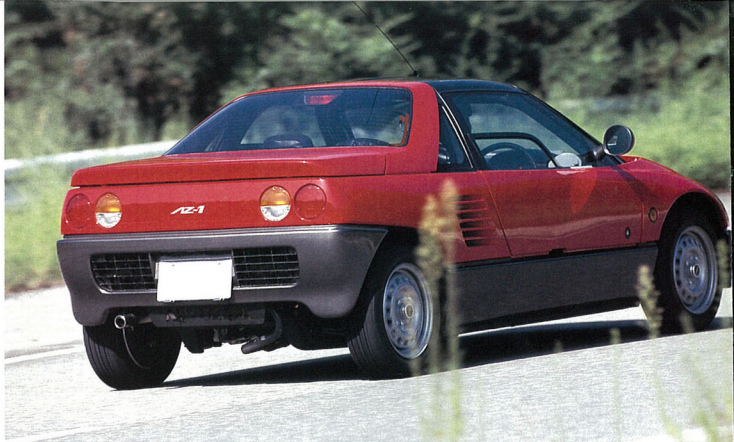
▲AZ-1は駆動輪である後輪にズシリとエンジンの荷重がかかるミッドシップ・レイアウトだから、直進加速時のトラクション能力は抜群だ。
