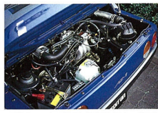
▲アルトワークス用3気筒DOHCターボを移植したA2-1のパワーソース。レスポンスのよさはタイトな乗車フィールでさらに倍加され、文句なしに「速い」。
