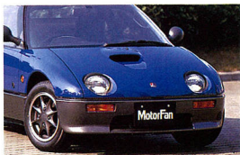
▲フロントフードのエアスクープは、室内への空気取り入れ口だ。
