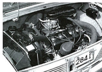
▲エンジンはオールアルミ製の4気筒。
