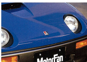
▲ボンネットの外板など主要な部分はSMC（シートモールディング・コンパウンド）を採用した。
