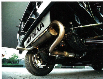
▲大型のサイレンサーをもつエキゾーストシステムは、オールステンレス製だ。
