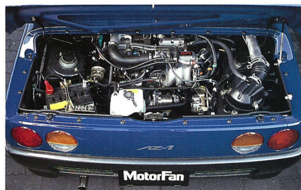
▲エンジンはミッドにマウントされる。エンジンフードを開けるとF6A型パワーユニットがあり、開口部が広くて整備しやすい。このパワーユニットはスズキ統括から供給されるもので、カプチーノと同じエンジンである。最高出力64ps/6500rpm、最大トルク8.7kgm/4000rpmを発揮する。
