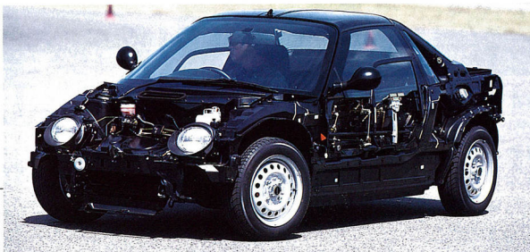
▲ボディ外板は、ボンネット、ルーフに至るまですべてプラスチック製だ。その重量は31kgで、同じ外板をスチール製にした場合より約5kg軽い。また、防錆性能に優れていることも特徴のひとつ。
