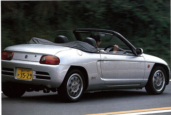
▲AZ-1同様、ミッドシップ・レイアウトを採ったビート。回頭性、旋回特性のウエルバランスはさすがである。
